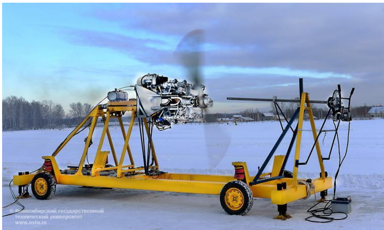
Рис. 1. Двигатель демонстратор технологий «Аэроэндуро» на испытательном стенде, п/п «Мочище» (январь 2018 г.)
